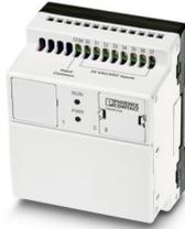
Unità di base Nanoline 24 V DC. Equipaggiata con 8 ingressi digitali, 2 ingressi analogici (0-10 V) e 4 canali di uscita PNP. Si possono aggiungere canali I/O e applicare fino a 3 moduli di espansione I/O. Moduli di comunicazione opzionali permettono il collegamento alla rete o il collegamento seriale. Un dispositivo di gestione opzionale mettere a disposizione un'interfaccia utente. La programmazione avviene mediante nanoNavigator.
