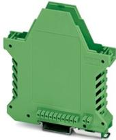
Custodie per guide DIN, Base custodia con piedino di fissaggio in metallo, design alto, con feritoie di ventilazione, larghezza: 17,6 mm, altezza: 99 mm, profondità: 107,3 mm, colore: verde (simili RAL 6021), collegamento trasversale: connettore bus integrato, n. poli connettore trasversale: 10+2, Connettore bus: 10 contatti paralleli, 2 contatti seriali
