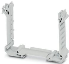
Custodie per guide DIN, Elemento intermedio per l'estensione modulare del volume della custodia, di tipo alto, con feritoie di ventilazione, larghezza: 22,6 mm, altezza: 99 mm, profondità: 74 mm, colore: grigio chiaro (simili RAL 7035), collegamento trasversale: senza connettore bus, n. poli connettore trasversale: non rilevante
