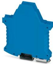
Custodie per guide DIN, Base custodia con piedino di fissaggio in metallo, design alto, con feritoie di ventilazione, larghezza: 17,6 mm, altezza: 99 mm, profondità: 107,3 mm, colore: blu (simili RAL 5015), collegamento trasversale: Connettore per guide di supporto (opzionale), n. poli connettore trasversale: 5
