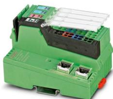
Inline, Accoppiatore bus, Sercos, Connettore femmina RJ45, Ingressi digitali: 8, 24 V DC, tecnica di connessione: 3 conduttori, Uscite digitali: 4, 24 V DC, 500 mA, tecnica di connessione: 3 conduttori, velocità di trasmissione nel bus locale: 500 kBit/s / 2 MBit/s, grado di protezione: IP20, Connettori Inline, campi di siglatura e piastra terminale incl.
