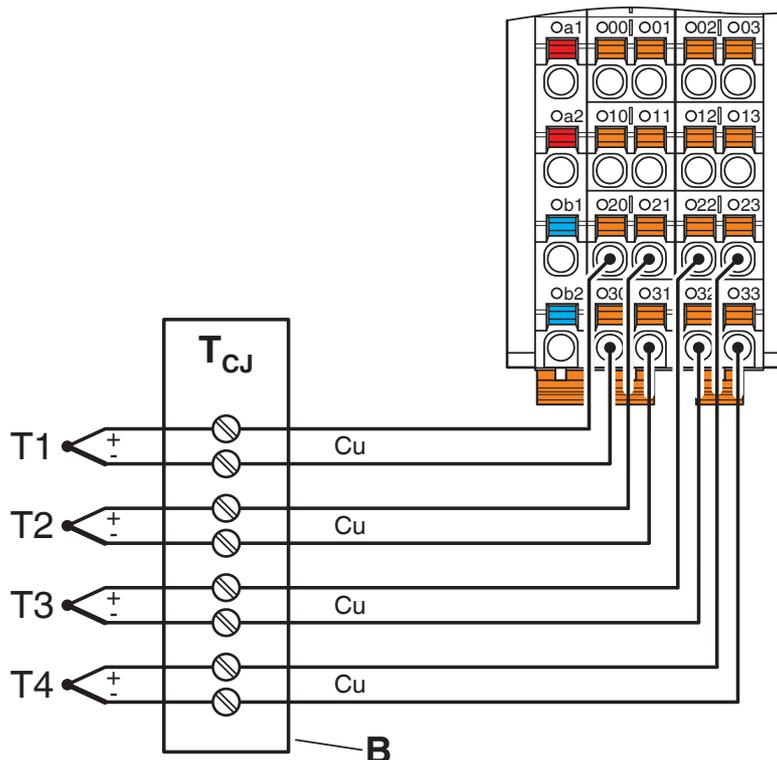
Rilevazione dei termoelementi con indicazione della temperatura del punto di confronto tramite dati di processo
