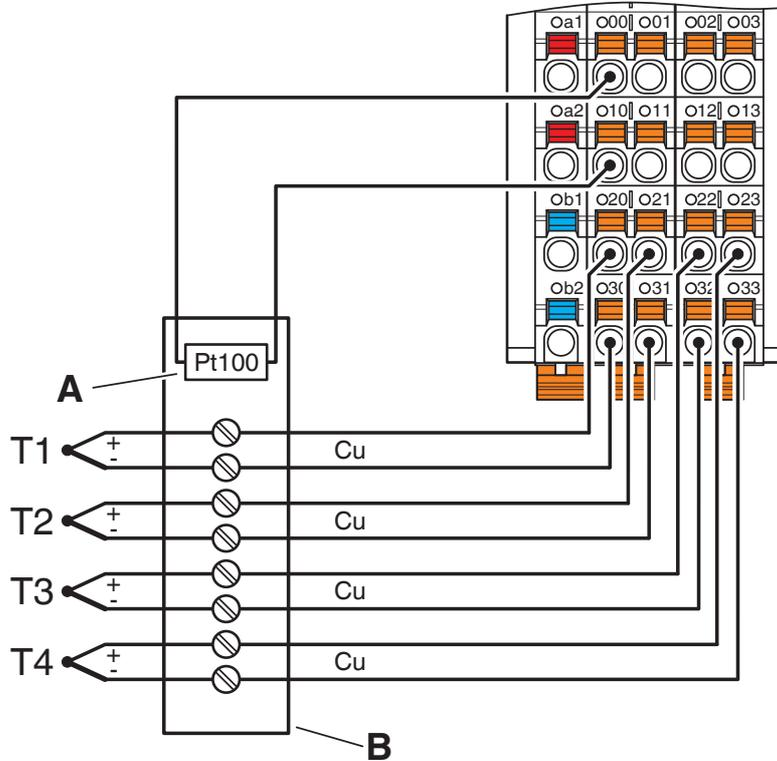
Rilevamento termocouple con compensazione esterna del punto di confronto sul canale 1
