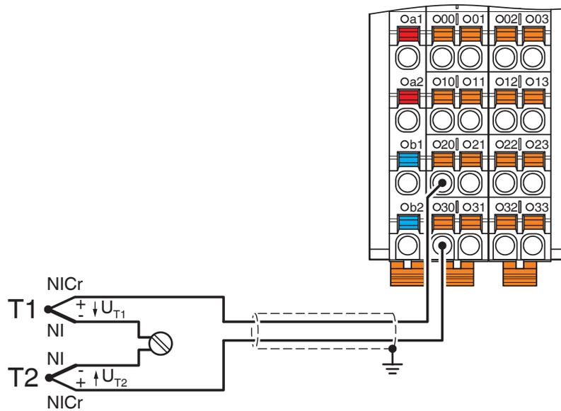
Misurazione differenza di temperatura
