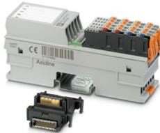
Axioline F, Modulo per il rilevamento della temperatura, Ingressi analogici: 4 (4 ingressi per termocoppie o tensione lineare, in aggiunta 1 ingresso -5 V a +5 V), tecnica di connessione: 2 conduttori (twisted pair schermati), velocità di trasmissione nel bus locale: 100 MBit/s, grado di protezione: IP20, incluso modulo di base bus e connettori Axioline F
