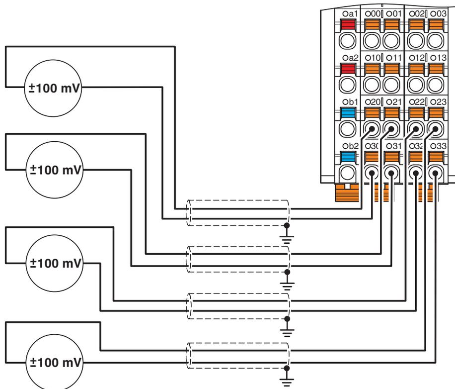
Misurazione di tensioni lineari  $\pm 100$  mV
