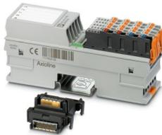
Axioline F, Modulo di ingresso analogico, Ingressi analogici: 4, 0 mA ... 20 mA, 4 mA ... 20 mA, - 20 mA ... 20 mA, tecnica di connessione: 2, 3, 4 conduttori, velocità di trasmissione nel bus locale: 100 MBit/s, alimentazione sensori integrata, grado di protezione: IP20, incluso modulo di base bus e connettori Axioline F
