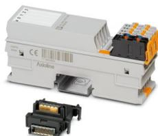
Modulo funzione Axioline F, 1 interfaccia SSI per encoder assoluto, 1 uscita analogica: 0-10 V,  $\pm 10$  V, 0-5 V,  $\pm 5$  V, 0-20 mA, 4-20 mA,  $\pm 20$  mA, connessione a 2 conduttori (incluso modulo di base bus e connettori)
