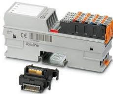
Axioline F, Modulo di uscita digitale, Uscite digitali: 16, 24 V DC, 500 mA, tecnica di connessione: 1 conduttore, velocità di trasmissione nel bus locale: 100 MBit/s, grado di protezione: IP20, incluso modulo di base bus e connettori Axioline F
