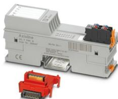
Axioline F, Modulo di backfeed per alimentazione logica  $U_{Bus}$ , max. 4 A, velocità di trasmissione nel bus locale: 100 MBit/s, grado di protezione: IP20, incluso modulo di base bus e connettore Axioline F
