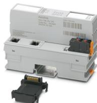
Axioline F, Accoppiatore bus, PROFINET, Connettore femmina RJ45, velocità di trasmissione nel bus locale: 100 MBit/s, grado di protezione: IP20, incluso modulo di base bus e connettore Axioline F
