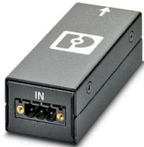
Il PC-PWR-FLTR-2 immagazzina la potenza in ingresso fino al raggiungimento della tensione di esercizio. Per l'impiego con sorgenti di tensione da 24 V DC con tempi di risposta superiori a 100 ms per max. 7 A.
