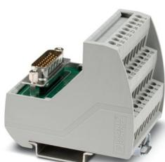
Modulo VARIOFACE, con connessione a vite e connettore maschio D-SUB miniaturizzato High Density, per l'installazione su guide di montaggio NS 35, n. poli: 26, larghezza: 79 mm
