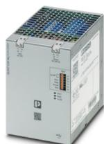
Modulo capacitivo QUINT, con accumulo esente da manutenzione su condensatore a doppio strato, Montaggio su guida DIN, ingresso: 24 V DC, uscita: 24 V DC / 5 A / 4 kJ incl. adattatore universale per il fissaggio su guida DIN UTA 107. Per la parametrizzazione può essere utilizzato il software POWER MANAGEMENT SUITE (cod. art. 1252232) dall'area di download.
