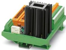
8-kanaliges Digital-Ausgabemodul mit Schraubanschluss und integrierter Messertrennfunktion. Redundante Spannungseinspeisung mit Melderelais. Geeignet für die Yokogawa-Karte SDV 531.
