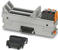
Modulo di base Axioline P per connettore di alimentazione PROFIBUS PA. In caso di installazione di due connettori fornisce la ridondanza per l'alimentazione di corrente del bus di campo.
