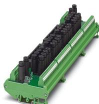
Modulo a 32 canali con connessione a vite a 1 conduttore e un fusibile per ogni linea di segnale (5 x 20 mm). L'alimentazione di tensione e la connessione di sistema a 50 poli sono ridondanti. Indicato per schede Yokogawa ADV151 e ADV551.
