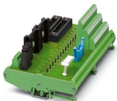
Modulo analogico a 16 canali con connessione a vite. L'alimentazione di tensione e la connessione di sistema a 40 poli sono ridondanti. Indicato per schede Yokogawa AAI141 e AAI143.
