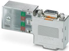
Connettore D-SUB, a 9 poli, spina, uscita cavo a 90°, sistema bus: PROFIBUS DP fino a 12 MBit/s con connettore femmina PG-D-SUB per il collegamento di un dispositivo di programmazione, resistenza di terminazione attivabile tramite interruttore a scorrimento, piedinatura: 3, 5, 6, 8; morsetti a vite
