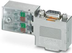
Connettore D-SUB, a 9 poli, spina, uscita cavo a 90°, sistema bus: PROFIBUS DP fino a 12 MBit/s con connettore femmina PG-D-SUB per il collegamento di un dispositivo di programmazione, resistenza di terminazione attivabile tramite interruttore a scorrimento, piedinatura: 3, 5, 6, 8; collegamento morsetti IDC
