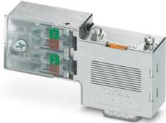
Connettore D-SUB, 9 poli, spina, uscita cavo a 90°, sistema bus: PROFIBUS DP fino a 12 MBit/s, resistenza di terminazione attivabile tramite interruttore a scorrimento, piedinatura: 3, 5, 6, 8; collegamento morsetti IDC
