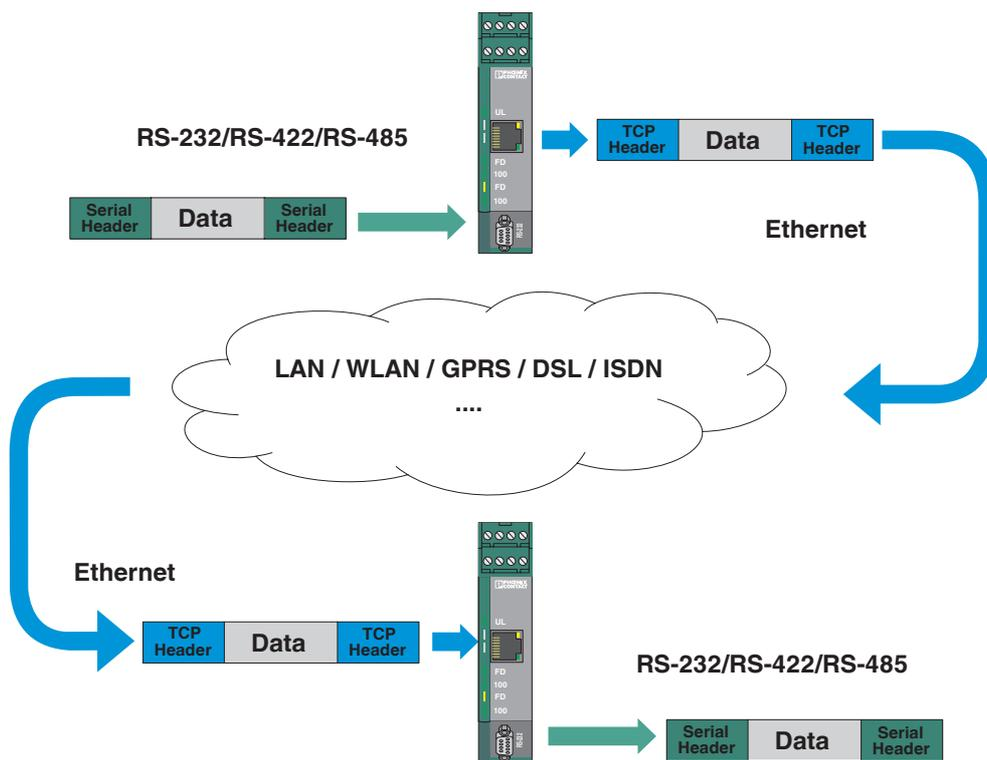
trasmissione dati seriale mediante Ethernet
