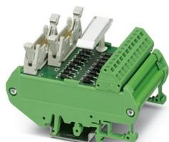
Modulo d'interfaccia VARIOFACE per la connessione ridondante di 2 x 8 canali d'uscita (SIMATIC® S7 / S5) mediante 2 x FLK14 su morsetti a molla. I segnali vengono disaccoppiati mediante diodi
