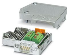
Connettore D-SUB, 9 poli, maschio, con due ingressi cavi a 35°, per sistemi bus: per accoppiatori bus Inline Modbus RTU/ASCII, resistenza terminale inseribile mediante interruttore a scorrimento, piedinatura: 3, 5, 6, 8; morsetti a vite
