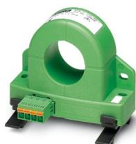
Convertitori di corrente universali per la misurazione di correnti continue, alternate e distorte, corrente d'ingresso 0 ... 500 A, uscita 4 ... 20 mA
