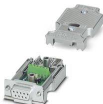
Connettore D-SUB, 9 poli, femmina, versione assiale con due ingressi cavi, per sistemi bus: CAN, CANopen, SafetyBus-P; piedinatura: 2,3,7; morsetti a vite
