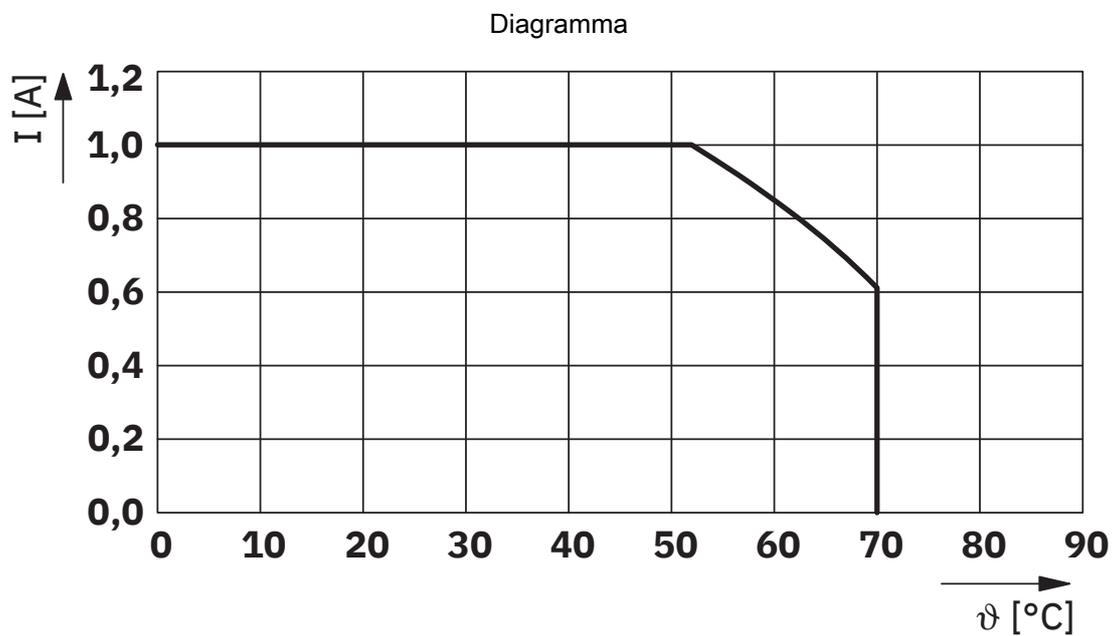
Corrente max. ammessa per circuito in stato di svolgimento
