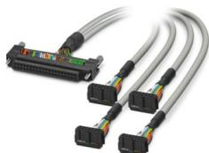
Cavo intestato; controllore: OMRON CJ1 (ID 231, ID 261), CQM1 (ID 213, ID 214), CS1, C200H (ID 111, ID 216, ID 217); connessione 1: Connettore Fujitsu (1x 40-poli); connessione 2: IDC/FLK conduttore femmina (4x 14-poli); lunghezza cavo: 2 m
