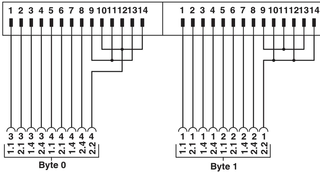
Schema di collegamento FLKM 14-PA-INLINE/OUT16
