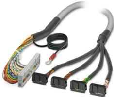
Cavo circolare confezionato schermato; controllore: Yokogawa CS3000 CentumVP (ADV561, ADV161); connessione 1: IDC/FLK conduttore femmina (1x 50-poli); connessione 2: IDC/FLK conduttore femmina (4x 14-poli); lunghezza cavo: 15 m
