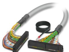
Cavo circolare confezionato schermato; connessione 1: IDC/FLK conduttore femmina (1x 50-poli); connessione 2: IDC/FLK conduttore femmina (1x 50-poli) (La treccia schermata è prevista su un'estremità separata del cavo.); lunghezza cavo: 2 m
