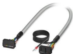
Cavo circolare confezionato schermato; connessione 1: IDC/FLK conduttore femmina (1x 14-poli); connessione 2: IDC/FLK conduttore femmina (1x 14-poli) (La treccia schermata è prevista su un'estremità separata del cavo.); lunghezza cavo: 2 m
