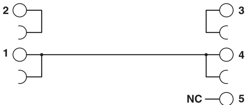
Schema di collegamento PLC-VT
