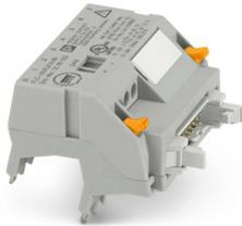
Adattatore V8 per 8 x PLC-INTERFACE (6,2 mm), controllore: Cablaggio di sistema PLC delle schede d'ingresso, collegamento 1: Connettore maschio IDC/FLK 1x 14-poli, collegamento 2: Attacco connettore (Può essere agganciato a scatto su 8 morsetti PLC-INTERFACE), collegamento 3: Connessione a vite 1x 2-poli, numero di canali: 8, logica di comando: a commutazione positiva
