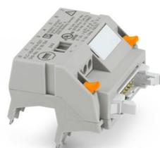
Adattatore V8 per 8 x PLC-INTERFACE (6,2 mm), controllore: Cablaggio di sistema PLC delle schede di uscita, collegamento 1: Connettore maschio IDC/FLK 1x 14-poli, collegamento 2: Attacco connettore (Può essere agganciato a scatto su 8 morsetti PLC-INTERFACE), collegamento 3: Connessione a vite 1x 2-poli, numero di canali: 8, logica di comando: a commutazione positiva
