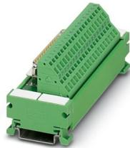
Modulo VARIOFACE con connessione a molla e connettore femmina D-Sub, per montaggio su NS 35/7,5, n. poli 9
