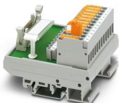
Modulo d'interfaccia VARIOFACE, per 8 canali con morsetti con sezionatore a coltello e prese di prova verso il lato campo e del sistema
