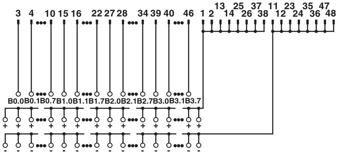
Schema di collegamento FLKMS 50/32IM/PLC
