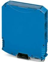
Custodie per guide DIN, Custodia completa con piedino di fissaggio in metallo, design alto, senza feritoia di ventilazione, larghezza: 22,6 mm, altezza: 99 mm, profondità: 113,65 mm, colore: blu (simili RAL 5015), collegamento trasversale: Connettore per guide di supporto (opzionale), n. poli connettore trasversale: 5
