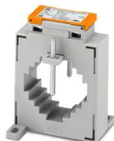
Trasformatore di corrente ad innesto, corrente primaria 800 A AC; corrente secondaria 5 A AC; classe di precisione 1; potenza nominale 10 VA
