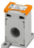
Trasformatore di corrente circolare, corrente primaria 250 A AC; corrente secondaria 5 A AC; classe di precisione 1; potenza nominale 5 VA
