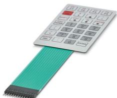
Tastiera a membrana autoadesiva, tecnica di comando in argento, 28 tasti, in rilievo, 4 colori, cavo di collegamento: 124 mm, con connettore femmina a crimpare, passo: 2,54 mm, temperatura d'impiego -20 °C ... 70 °C
