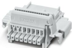
Connettore per guide di supporto, colore: grigio chiaro, corrente nominale: 6 A, 4 A (contatti paralleli) (contatti seriali), tensione di dimensionamento (III/2): 32 V, numero poli: 8, serie di prodotti: TBUS8-25.., passo: 2,54 mm, montaggio: Montaggio su guida DIN, bloccaggio: assente, tipo di fissaggio: assente, tipo di confezione: confezionato nel cartone, Articolo con contatti dorati, connettore bus per il collegamento con custodie per l'elettronica, 6 contatti paralleli/2 contatti seriali
