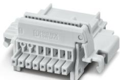
Connettore per guide di supporto, colore: grigio chiaro, corrente nominale: 6 A, 4 A (contatti paralleli) (contatti seriali), tensione di dimensionamento (III/2): 32 V, numero poli: 8, serie di prodotti: TBUS8-25.., passo: 2,54 mm, montaggio: Montaggio su guida DIN, bloccaggio: assente, tipo di fissaggio: assente, tipo di confezione: confezionato nel cartone, Articolo con contatti dorati, connettore bus per il collegamento con custodie per l'elettronica, 7 contatti paralleli/1 contatto seriale
