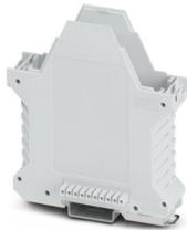
Custodie per guide DIN, Base custodia con piedino di fissaggio in metallo, con contatto FE, di tipo alto, senza feritoia di ventilazione, larghezza: 22,6 mm, altezza: 99 mm, profondità: 107,3 mm, colore: grigio chiaro (simili RAL 7035), collegamento trasversale: connettore bus integrato, n. poli connettore trasversale: 10, Connettore bus: 10 contatti paralleli
