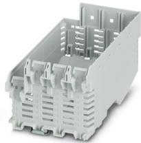
Custodie per guide DIN, Base custodia con piedino di fissaggio in metallo, con feritoie di ventilazione, larghezza: 75,87 mm, altezza: 120,6 mm, profondità: 64,3 mm, colore: grigio chiaro (simili RAL 7035), collegamento trasversale: Connettore per guide di supporto (opzionale), n. poli connettore trasversale: 5 oppure 8
