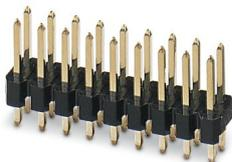
Connettore maschio, colore: nero, tipo di connessione del contatto: Spina, numero dei potenziali: 18, numero di file: 2, numero poli: 18, numero di connessioni: 18, serie di prodotti: PSTD 0,65X0,65/..-V, passo: 2,54 mm, montaggio: Saldatura THR, layout pin: Pinning lineare, lunghezza pin [P]: 2,5 mm, bloccaggio: assente, tipo di confezione: confezionato nel cartone
