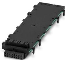
Connettore per guide di supporto, colore: nero, corrente nominale: 3 A (Corrente cumulativa max. 25 A), tensione di dimensionamento (III/2): 30 V, numero poli: 16, serie di prodotti: BC 107,6..., passo: 2,54 mm, montaggio: Montaggio su guida DIN, bloccaggio: assente
