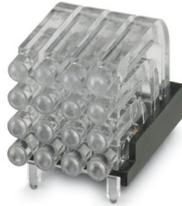
Conduttore di luce multiplo con protezione contro la sovraesposizione, passivo, rigido, A testa semisferica, superficie di emissione: sferica, numero di indicatori: 16, (4 file, 4 colonne), passo: 2,54 mm, protezione ESD: <8 kV, utilizzabile per le custodie ME, ME MAX, ME-IO, ME PLC e EH (modifica della custodia necessaria)
