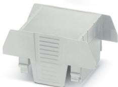
Custodie per guide DIN, Parte superiore della custodia, struttura piatta, apertura di connessione su entrambi i lati, larghezza: 45,1 mm, altezza: 74,65 mm, profondità: 36,95 mm, colore: grigio chiaro (simili RAL 7035)
