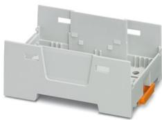
Custodie per guide DIN, Base custodia con piedino di fissaggio, design piatto, senza feritoia di ventilazione, larghezza: 45,1 mm, altezza: 75 mm, profondità: 30,3 mm, colore: grigio chiaro (simili RAL 7035), collegamento trasversale: senza connettore bus, n. poli connettore trasversale: non rilevante
