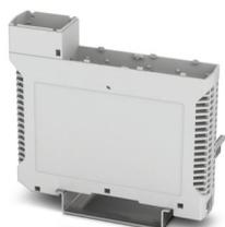
Custodie per guide DIN, Base custodia con piedino di fissaggio in metallo, per connettori bus 10/10, larghezza: 39,7 mm, altezza: 180,1 mm, profondità: 137,7 mm, colore: grigio chiaro (simili RAL 7035), collegamento trasversale: Connettore per guide di supporto (opzionale), n. poli connettore trasversale: 10
